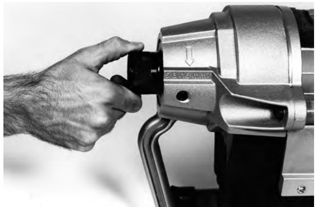
Figura 10 – Ajuste del conjunto de la mordaza
