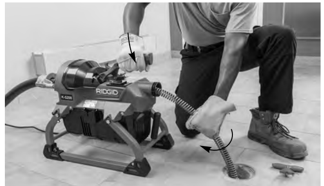
Figura 11 A – El embrague está activado, el cable está girando y el operario está metiendo el cable por el desagüe
