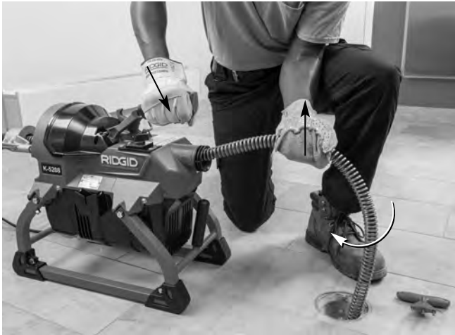
Figure 14A – Retrait du câble de la canalisation avec embrayage engagé et câble en rotation
