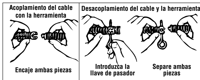
Figura 5 – Acoplamiento y desacoplamiento de herramientas
