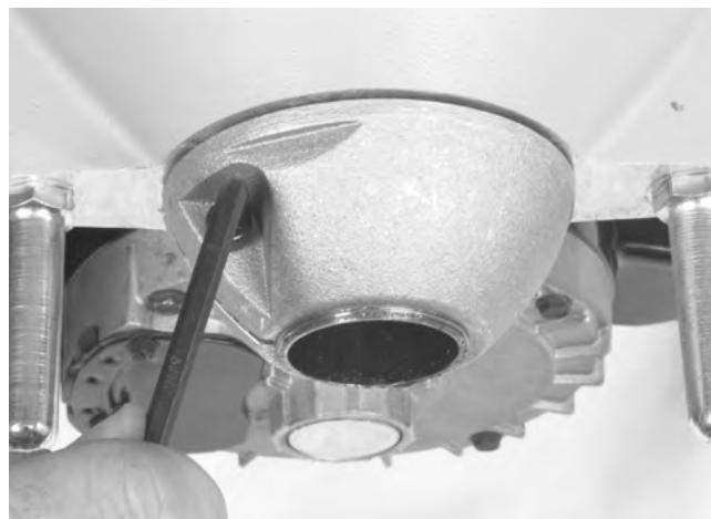
Figure 14 – Réglage de l'embrayage
