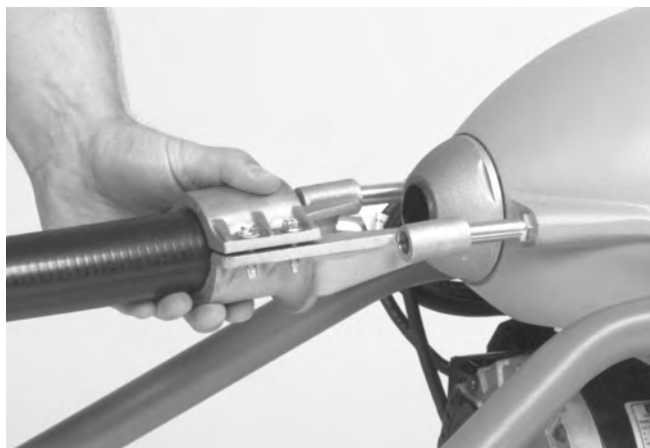
Figura 3 – Conexión de la manguera guía trasera
