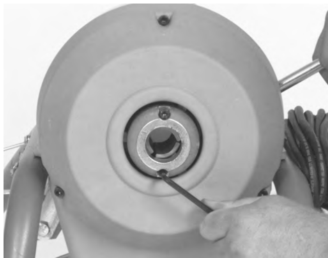
Figure 12 – Remplacement des mâchoires d'embrayage
