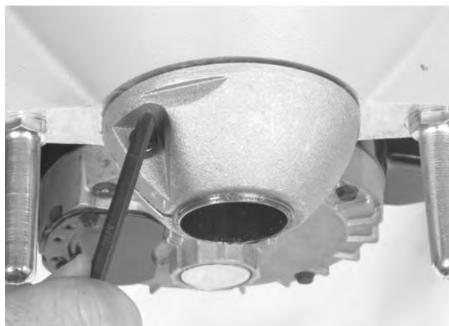
Figura 14 – Eliminación de la holgura del embrague
