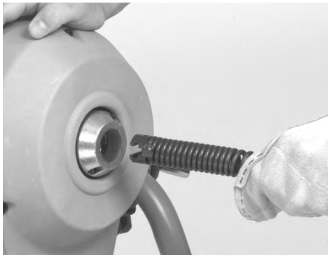
Figure 4 – Introduction du câble via l'avant du dégorgeoir
