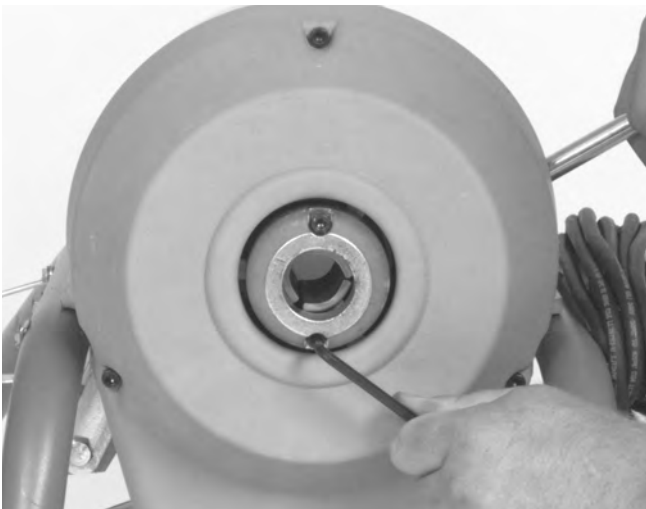
Figura 12 – Recambio de las mordazas del embrague
