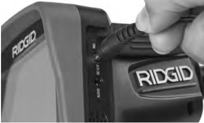
Şekil 6 - Üniteye AC Adaptörü ile Güç Verme
