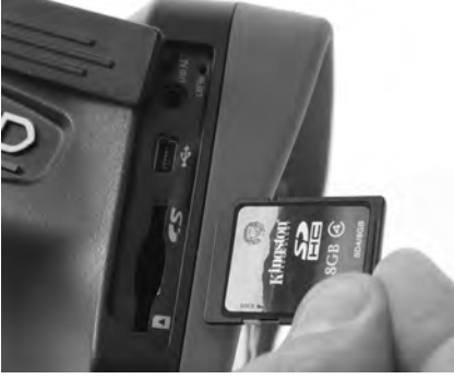
Şekil 9 - SD Kartın Takılması
