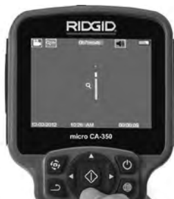
Рис. 15 - Настройка изменения масштаба изображения
