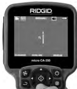
Figura 15 – Ajuste del zoom
