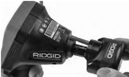
Рис. 18 - Вилка разъема видеокамеры подключена
