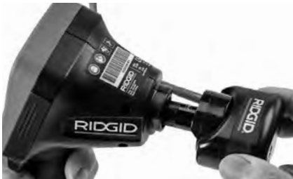
Figure 18 – Connexion du câble de tête de caméra
