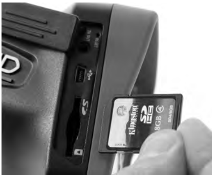
Figura 9 – Introducción de la tarjeta SD
