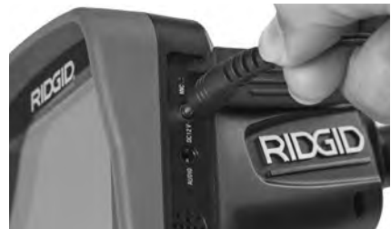
Рис. 6 - Питание прибора от адаптера переменного тока
