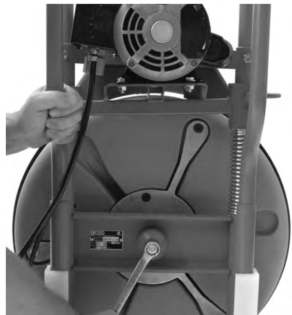
Figura 18 – Extracción del pasador del tambor
