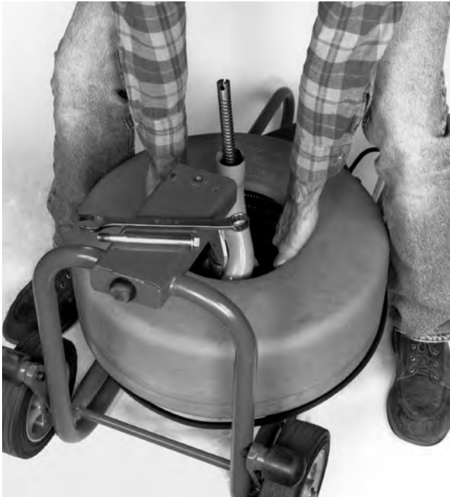
Figure 19 – Dépose du tambour
