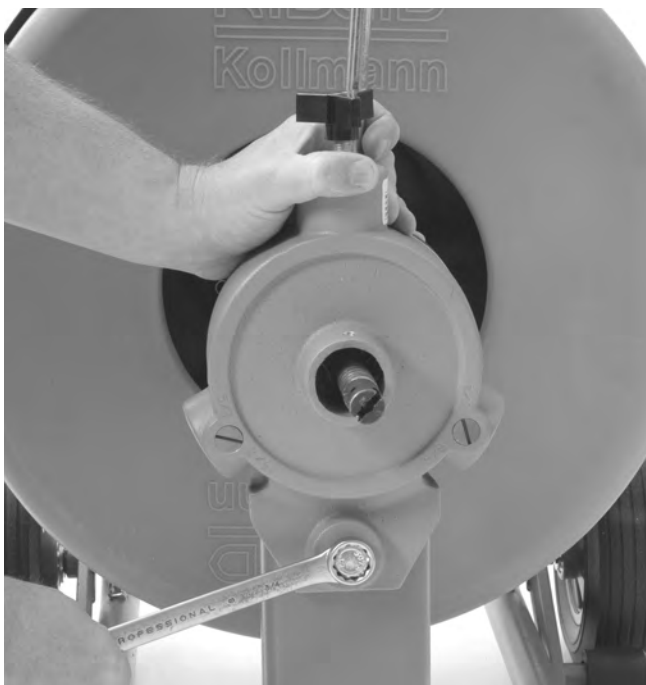
Figure 16 – Dépose de l'AUTOFEED
