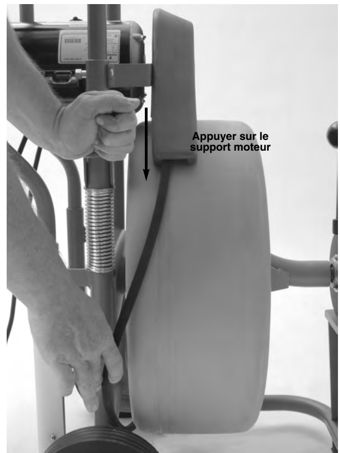
Figure 17 – Dégagement de la courroie
