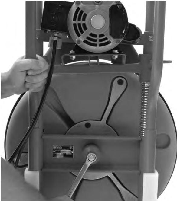
Figure 18 – Retrait du boulon du tambour
