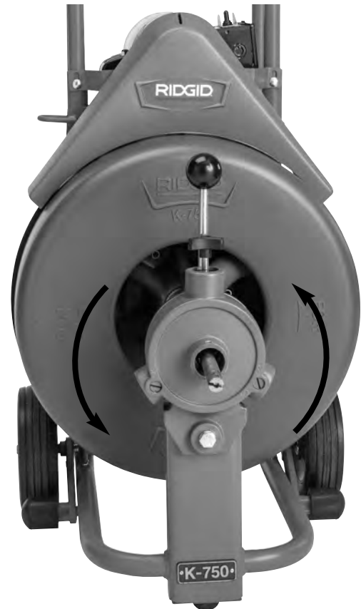
Figura 8 – Correcta rotación del tambor (conmutador en posición FOR)
