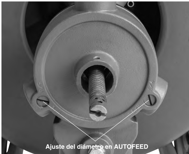
Figura 9 – Ajuste del diámetro en AUTOFEED
