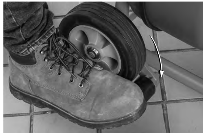
Figure 11 – Déploiement des béquilles
