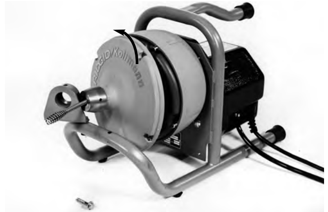
Figura 17 – Abra el tambor girando su tapa delantera hacia la izquierda
