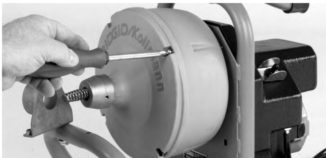
Figura 16 – Afloje los 4 tornillos unas 3 vueltas completas pero no los quite
