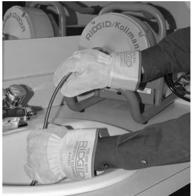
Figura 9 – Alimentación del cable en forma manual
