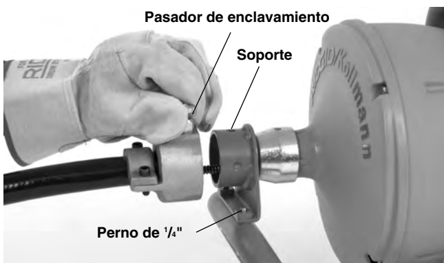
Figura 3 – Montaje de la manguera guía a la nariz de la K-40
