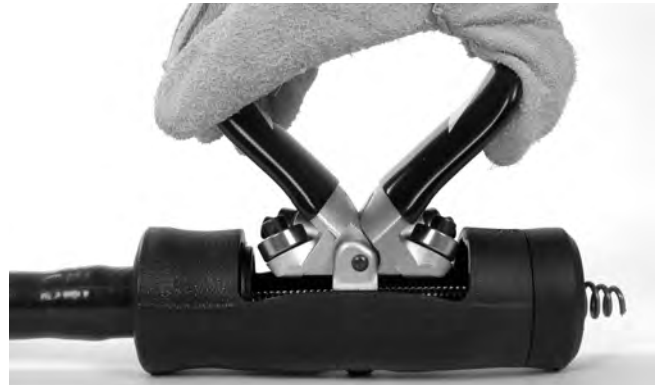
Figura 4 – Introducción del cable por el AUTOFEED
