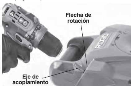
Figura 4 – Conexión del taladro al eje de acoplamiento
