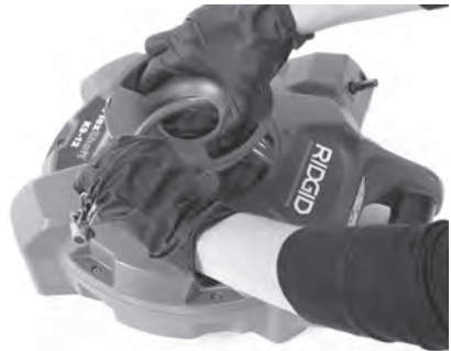
Figure 7C – Introduction du câble à travers le trou du capuchon Figure 7 – Retrait du dégorgeoir du tambour
